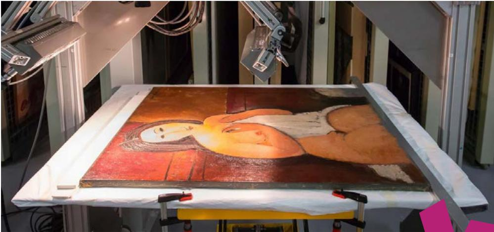
Nu assis à la chemise d'Amedeo Modigliani (1917) en cours d'analyse par imagerie hyperspectrale dans l'infrarouge court (1000 - 2500 nm) au LaM. Photo : N. Dewitte / LaM
